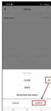
Réglage de l'état de la commande de la vanne en cas de coupure de courant
