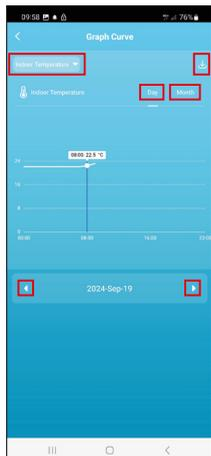
Fare clic sul rigo in alto a sinistra e selezionare il tipo di misura desiderato: temperatura interna, umidità interna, temperatura del sensore esterno n. 1,2,3, umidità del sensore esterno n. 1,2,3
